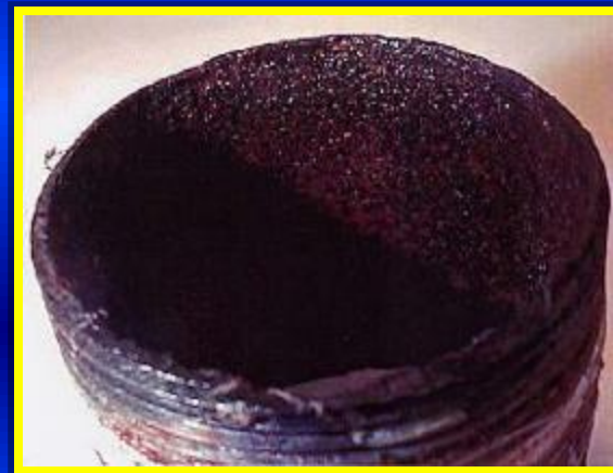
ภายใน 2-3 สัปดาห์ สนิมจะหายไป และจะเกิดชั้นฉนวนสีดำ ป้องกัน การเกิดสนิมในท่อเหล็ก
